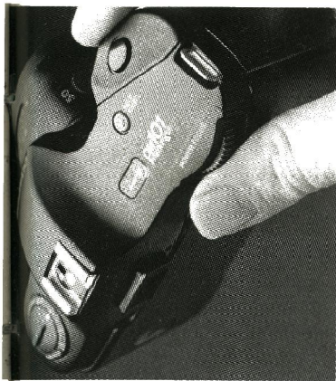
Knappen til »Power Focus« ligger perfekt ved tommelfingeren, og udløserknappen ved pegefingeren.
